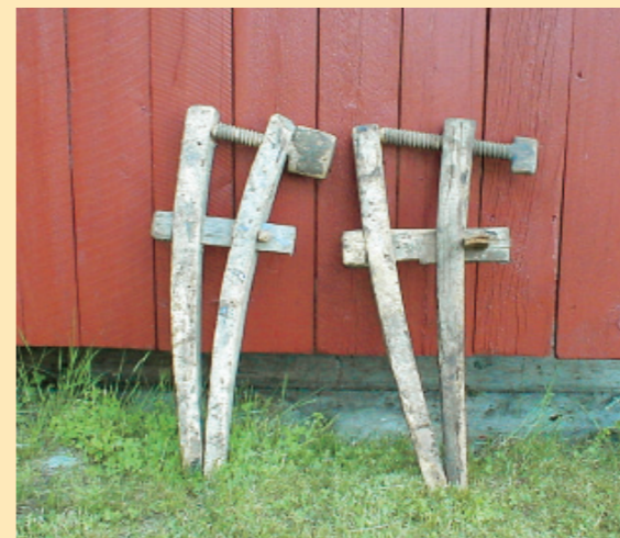
Båttvingar som heldt båtborda fast ved reparasjonar og bygging. FOTO: ATLE O. BOLSTAD.
